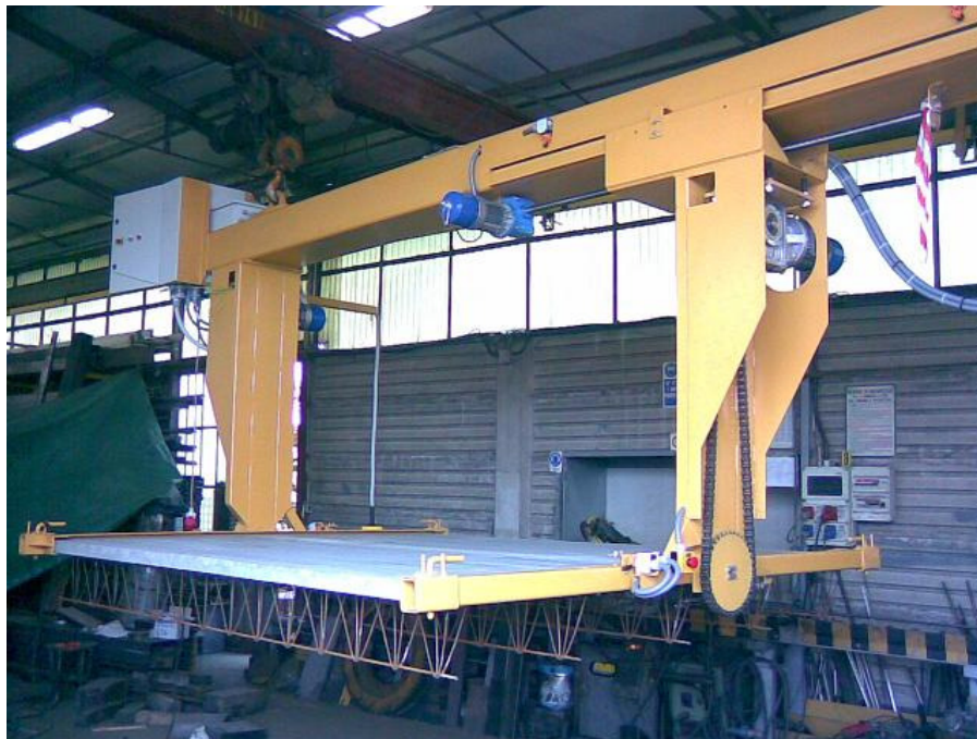
Attrezzatura per sollevamento e rotazione pannelli per l'edilizia.
